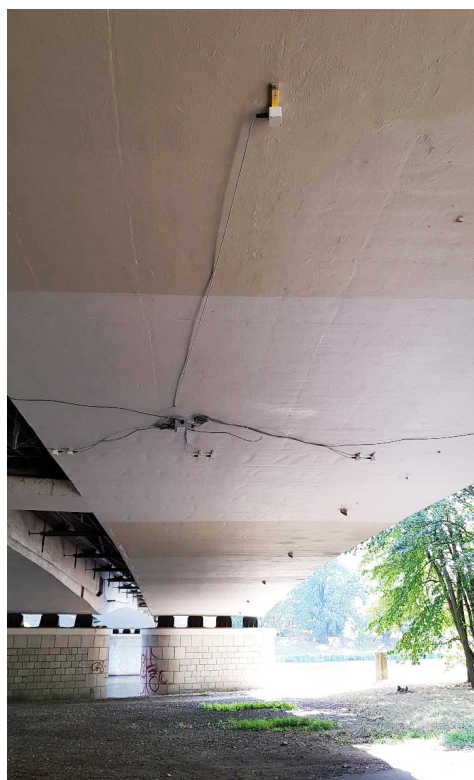
Obr. 3 Pohled na typickou instalaci systému iBWIM na zkoumané mostní konstrukci (vlevo), přejezd nákladního vozu pro kalibraci systému (vpravo nahoře), laserový snímač pro detekci přejezdu vozidel a identifikaci počtu náprav (vlevo dole).
