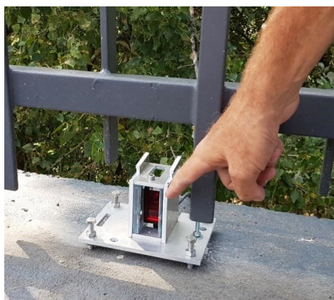
Obr. 3 Pohled na typickou instalaci systému iBWIM na zkoumané mostní konstrukci (vlevo), přejezd nákladního vozu pro kalibraci systému (vpravo nahoře), laserový snímač pro detekci přejezdu vozidel a identifikaci počtu náprav (vlevo dole).
